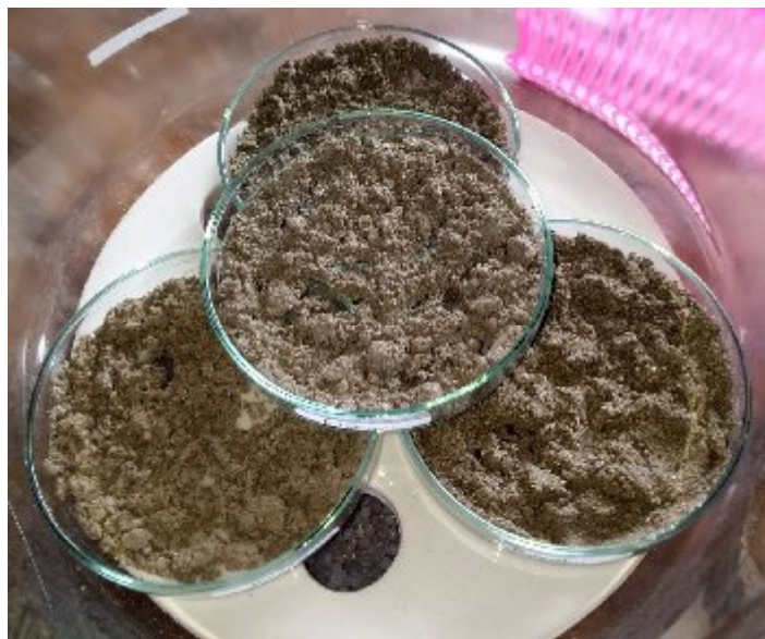
Sedimen setelah dikeringkan menggunakan Oven
