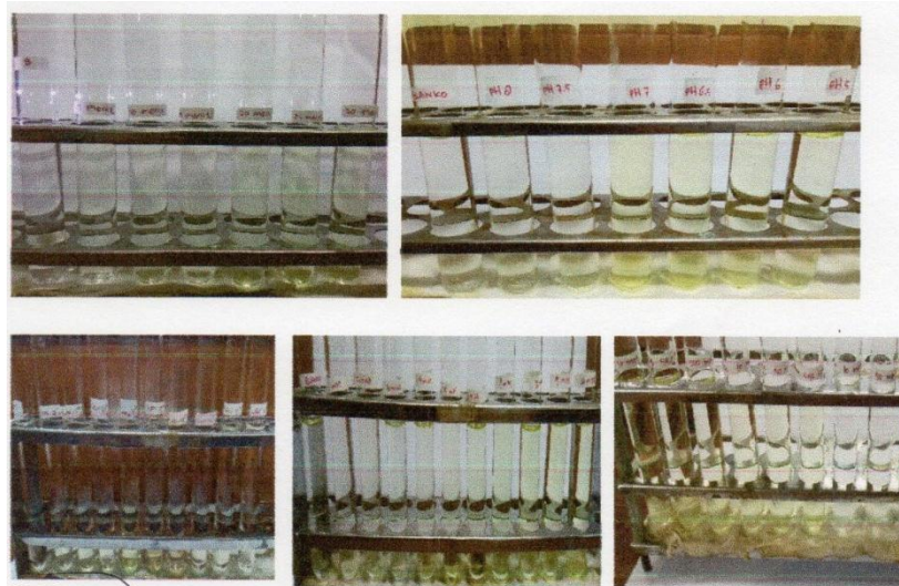
Tahapan karakterisasi enzim amobil (a) optimasi waktu; (b) optimasi pH; (c) optimasi suhu; (d) optimasi [substrat]; (e) pengaruh ion logam
