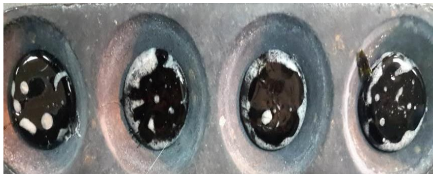
Gambar 8. Hasil leburan berbentuk ampas bijih (slag) dan logam mulia
