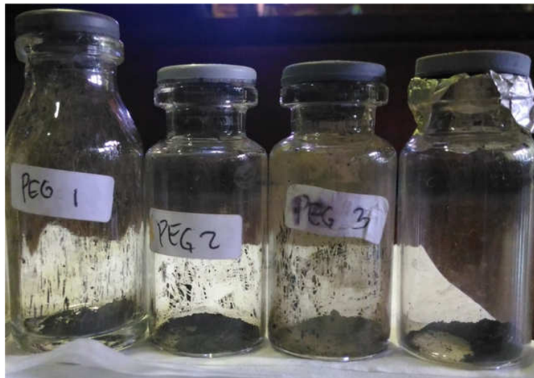
Gambar 4. Bentuk fisik magnetit pada penambahan 1,2,3 dan 4 gram poliethilen glikol
