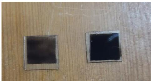
**Lampiran 7 perendaman lapisan TiO<sub>2</sub> pada dye**
