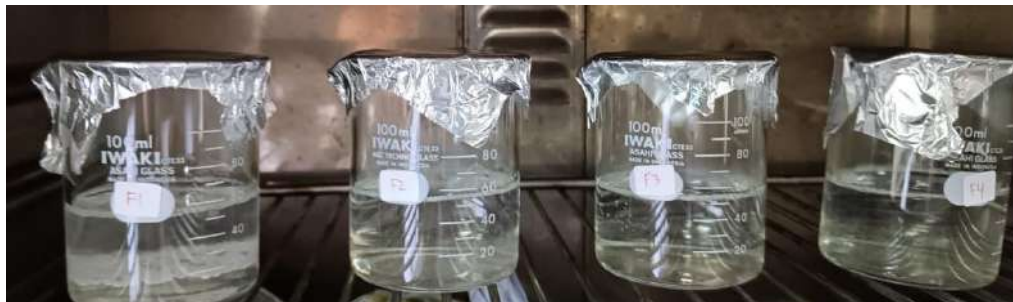
(a) PVA dilarutkan di dalam oven pada suhu 90°C
