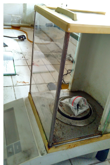
Gambar 5. Penimbangan sampel menggunakan Neraca Ohaus digital
