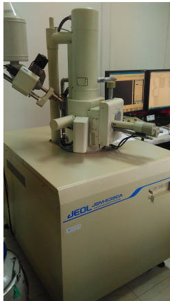
Gambar 16. Perangkat uji SEM Laboratorium Karakterisasi P2MM LIPI
