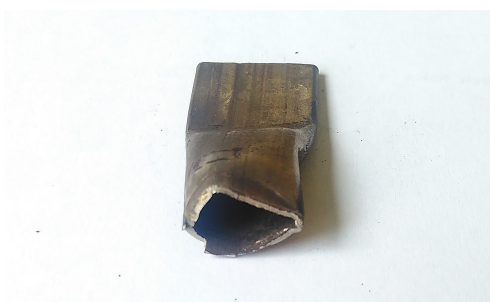
Gambar 11. Tube yang telah dibongkar dengan cara mekanik
