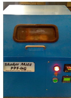
Gambar 4. Milling menggunakan Shaker Mill PPF-UG dengan vial milling di dalamnya
