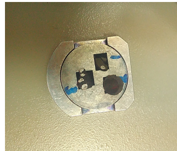
Gambar 17. Persiapan sampel di atas Holder SEM dalam bentuk bulk
