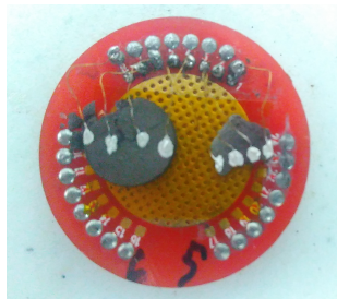
Gambar 15. Persiapan sampel di atas Holder cryogenic dalam bentuk bulk
