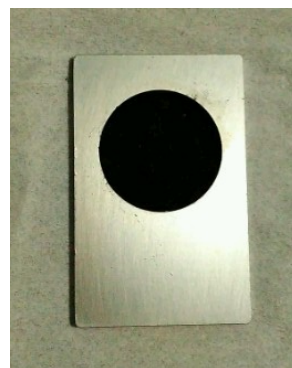
Gambar 19. Persiapan sampel di atas wadah aluminium XRD dalam bentuk serbuk
