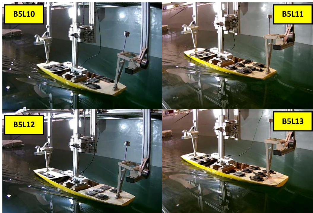
Gambar 27. Pengujian model untuk V_M 0,942 m/det.
