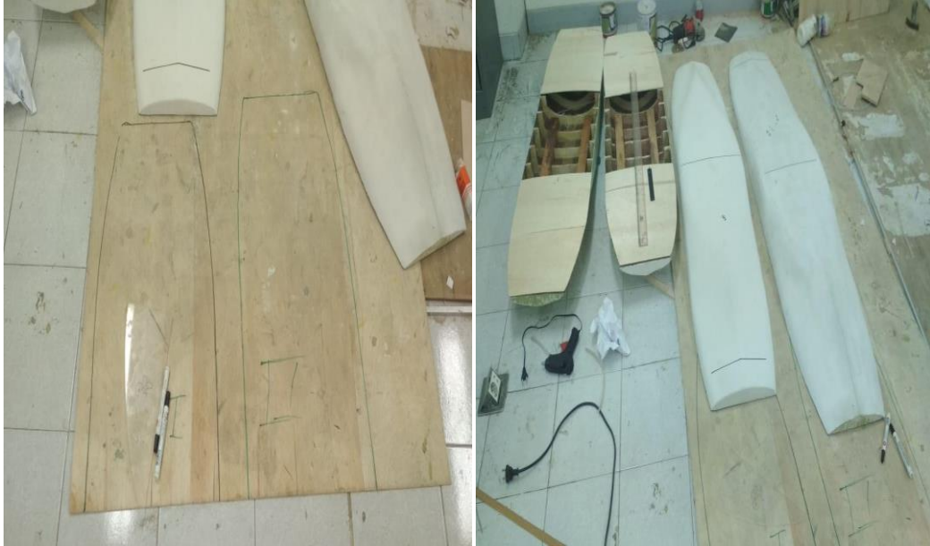
Gambar 18. Pemasangan main deck
