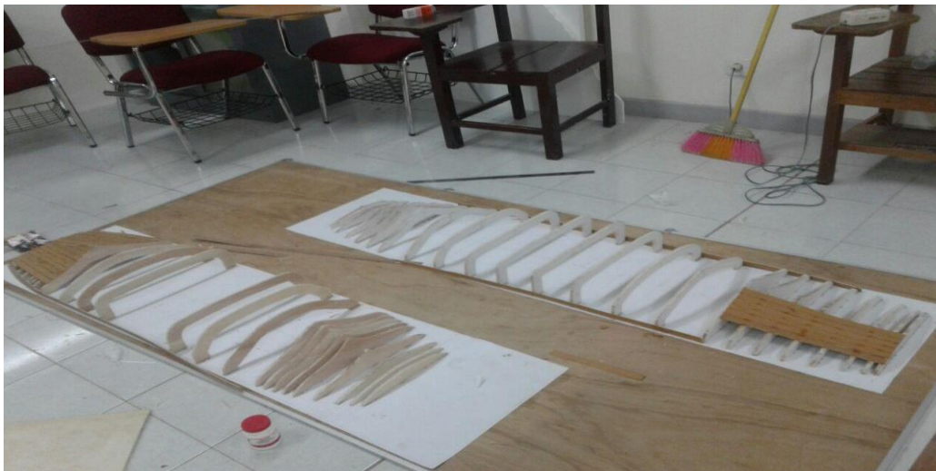
Gambar 13. Frame direkatkan pada pola waterline
