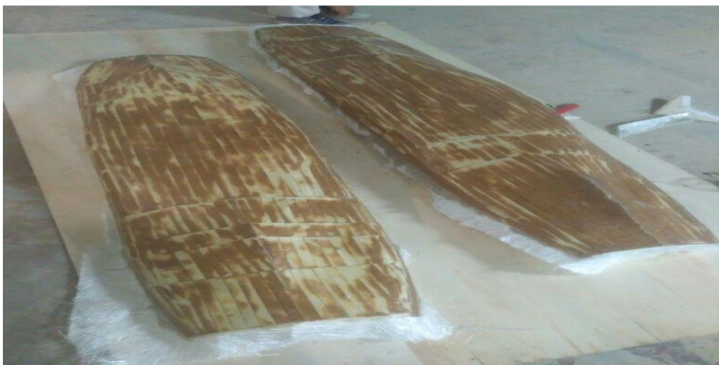
Gambar 15. Pemasangan fiber matt
