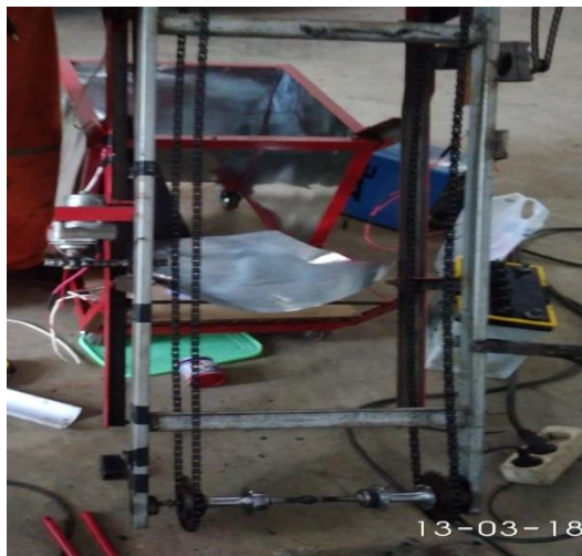
Gambar 4.3: rangka pengangkut sampah kanal sempit
