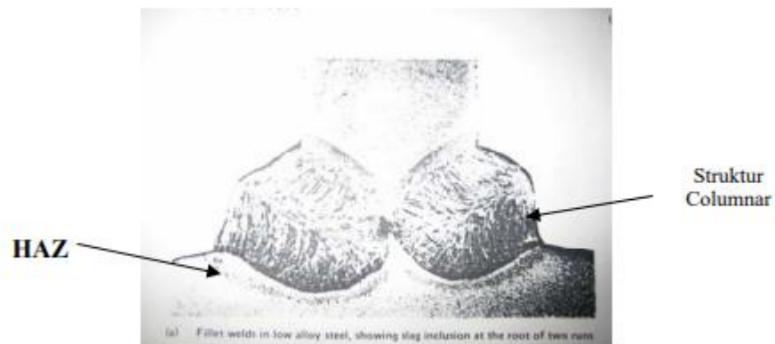
Gambar II.4 Struktur makro sambungan las (sumber: Riswan, 2008)
