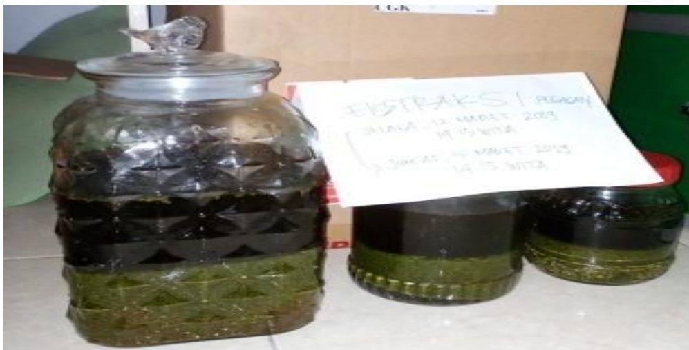
Melarutkan daun pegagan dengan etanol 70% selama 3 hari
