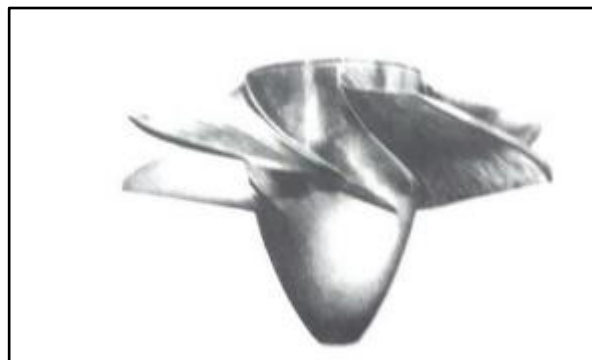
Gambar 2. 7 Roda baling-baling Turbin Kaplan (Sumber: Aroyono, T. 2019)
