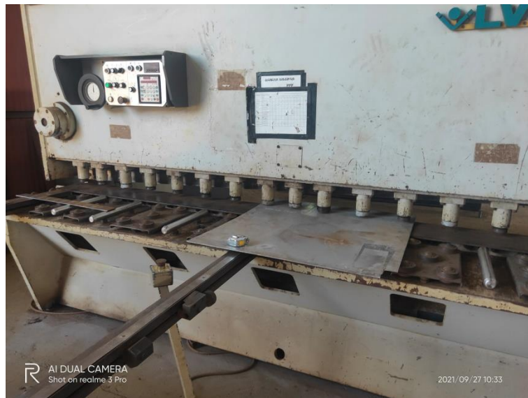
Lampiran 2.4 Menggunakan mesin shearing untuk memotong plat AISI 316L ukuran 800 mm x 800 mm x 6 mm menjadi 200 mm x 100 mm x 5 mm
