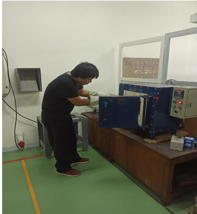
Lampiran 6.1 Spesimen DMW diberikan perlakuan panas dalam furnace dengan holding time 60 menit
