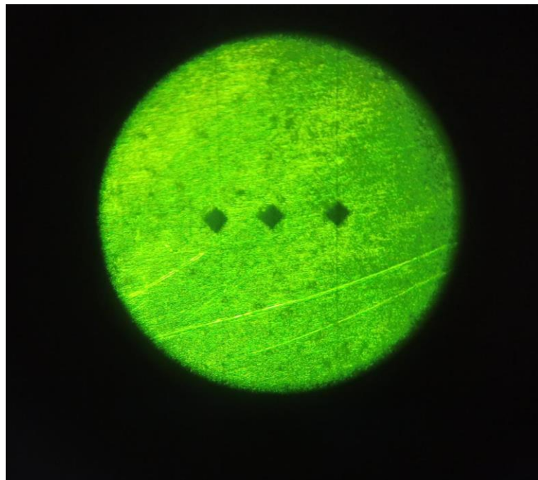
Lampiran 8.2 Hasil jejak uji kekerasan dengan perbesaran 100
