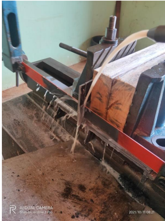
Lampiran 5.1 Memotong sampel DMW dengan ukuran masing-masing 13 mm
