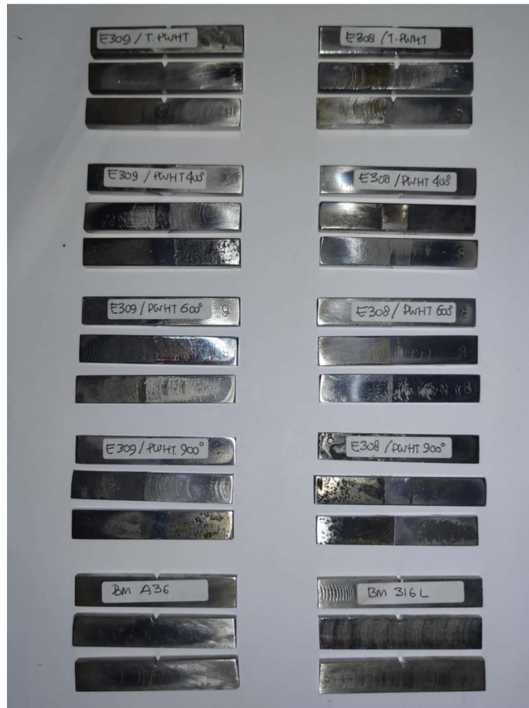
Lampiran 5.3 Model spesimen untuk pengujian hardness dan pengujian struktur mikro
