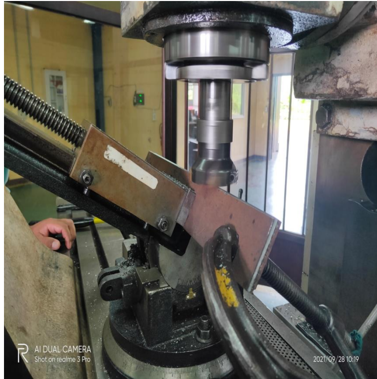
Lampiran 2.5 Menggunakan mesin frais untuk pembuatan kampuh V dengan sudut 30^\circ
