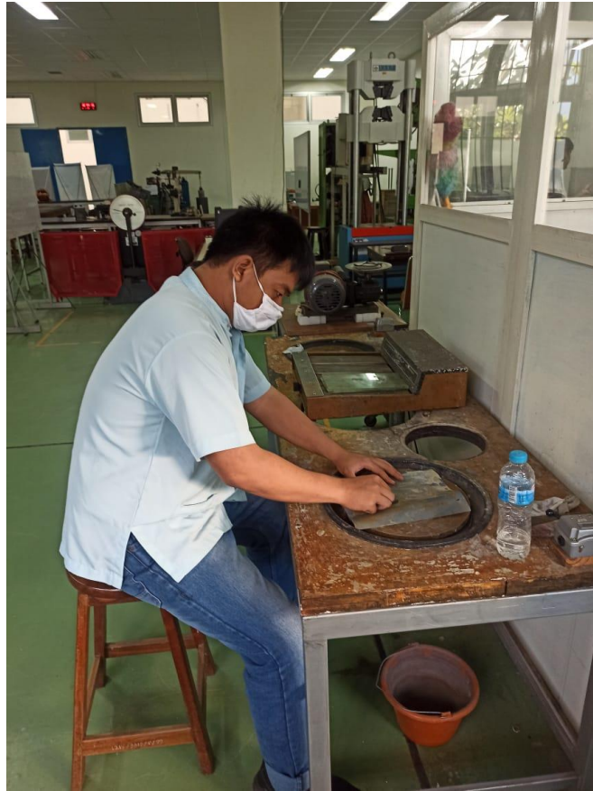
Lampiran 7.1 Proses pengamplasan bagian yang akan difoto struktur mikro
