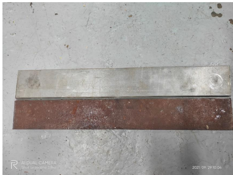
Lampiran 2.6 kedua plat yang sudah melalui proses pembuatan kampuh V akan dilakukan proses pengelasan
