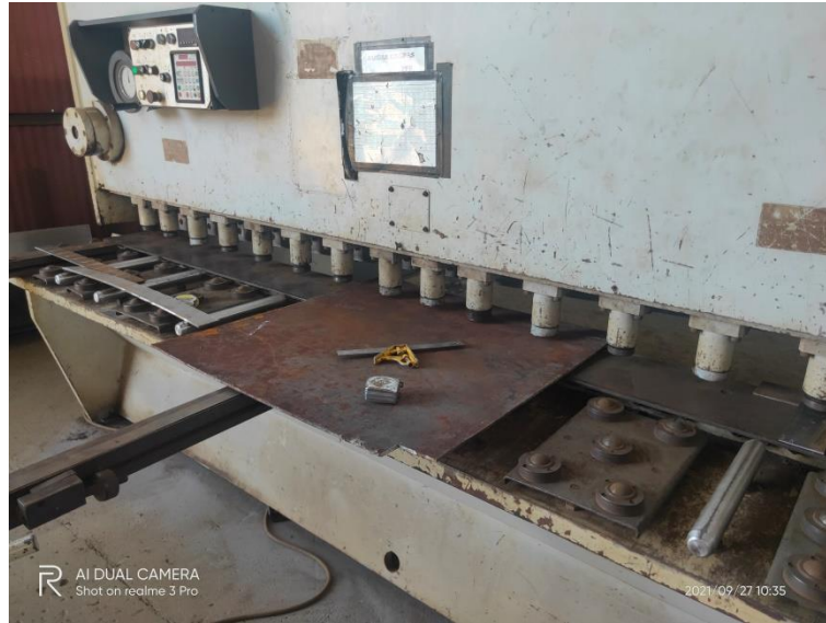
Lampiran 2.3 Menggunakan mesin shearing untuk memotong plat ASTM A36 ukuran 800 mm x 800 mm x 6 mm menjadi 200 mm x 100 mm x 5 mm
