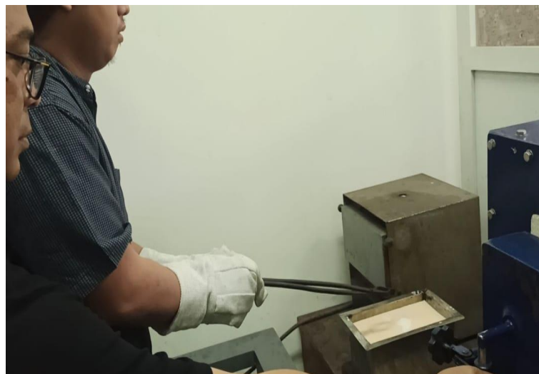
Lampiran 6.2 Spesimen memasuki proses pendinginan dengan cara dicelupkan ke media pendingin oli dromus 15%
