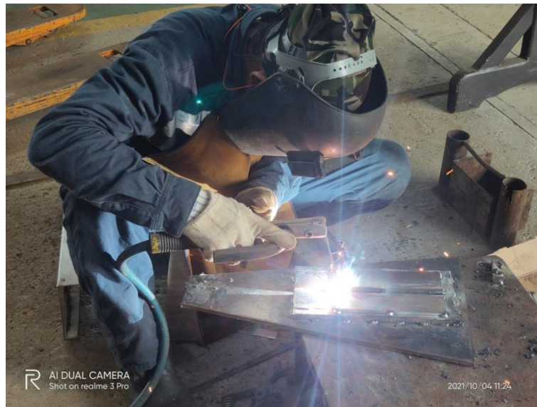
Lampiran 3.2 Pengelasan kedua plat ASTM A36 dengan AISI 316L
