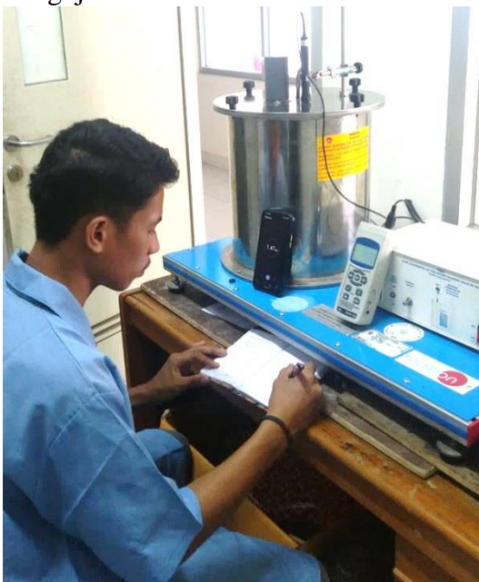
Pengujian nilai kalor bahan bakar
