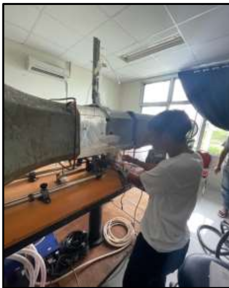
Proses pemasangan model uji pada wind tunnel
