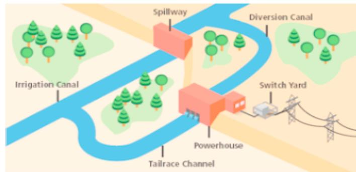
Gambar 6. Tipe Pembangkit Energi Air Aliran Dalam [14]
