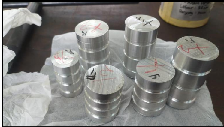
Foto Hasil pembubutan aluminium 6061
