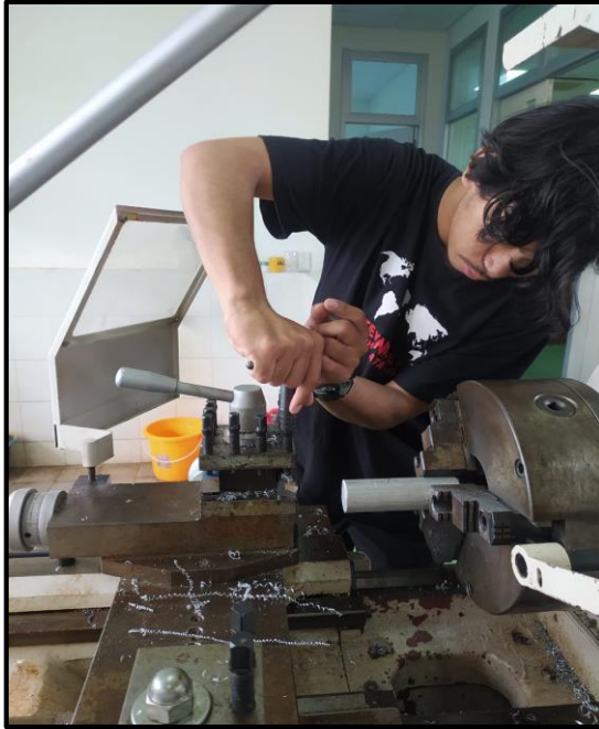
Foto Proses pemasangan pahat
