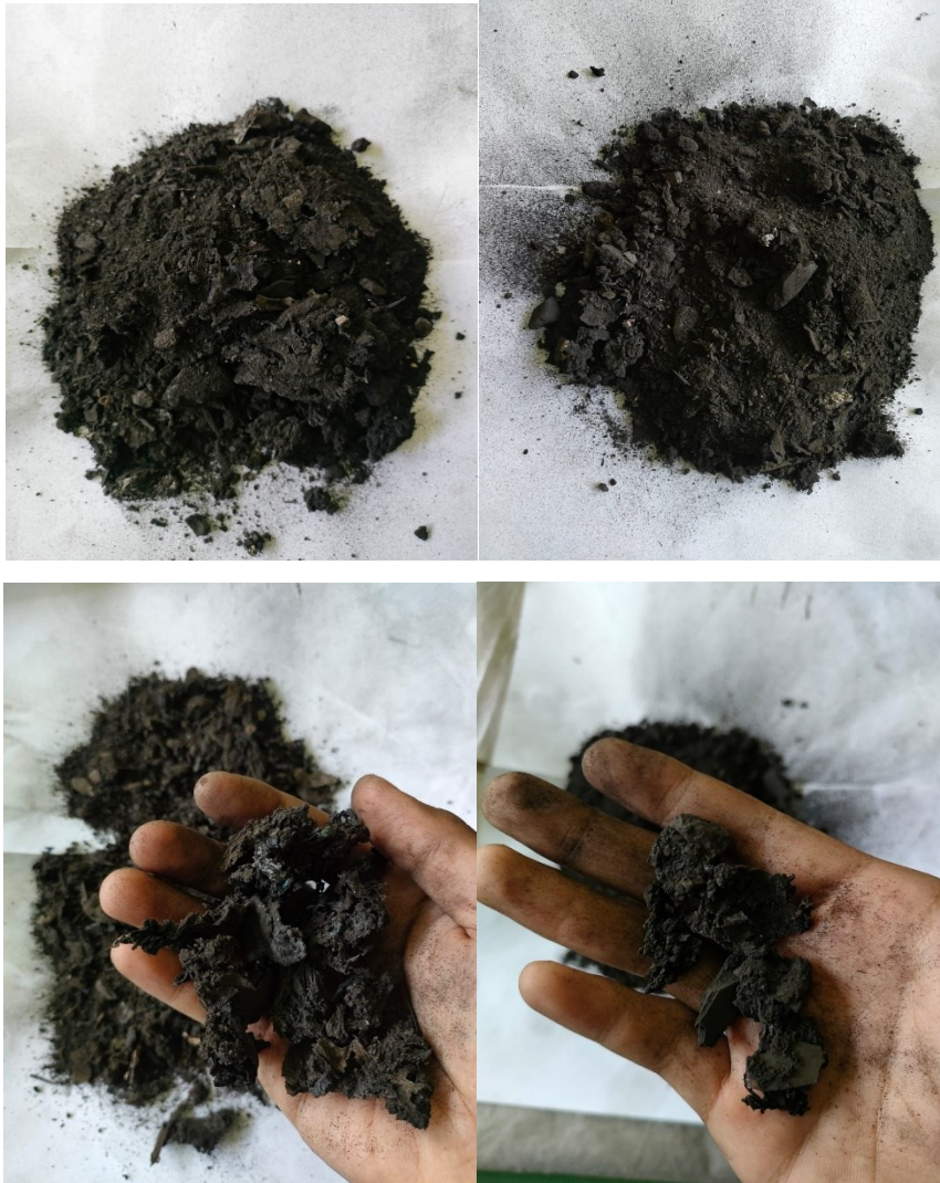
Sampel yang telah dipanaskan dengan Metode Pirolisis
