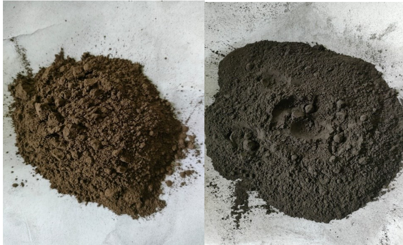
Sampel yang telah di Crusher dan di Ayak
