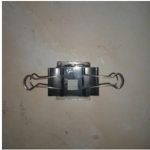
Gambar 10.3 Penyusunan lapisan sandwich DSSC secara offset
