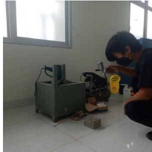
Gambar 3.7 Penyemprotan larutan \text{SnCl}_2
