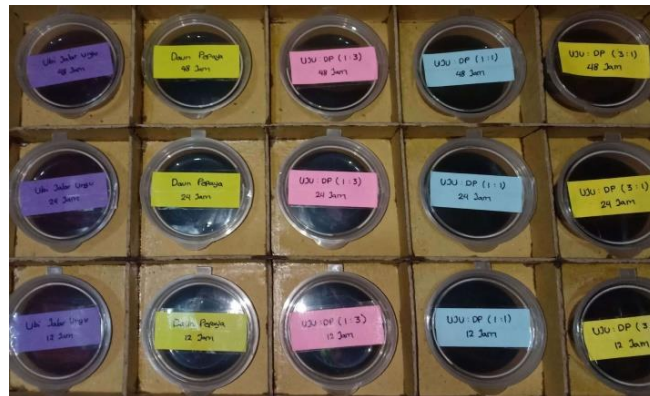
Gambar 7.4 Perendaman kaca yang telah dilapisi \text{TiO} pada dye
