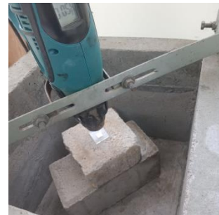
Gambar 7.3 Pemanasan lapisan tipis \text{TiO}_2 pada suhu 450^\circ\text{C} selama 30 menit
