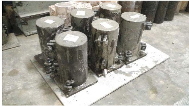
**Hasil Campuran Beton dalam *Mould***
