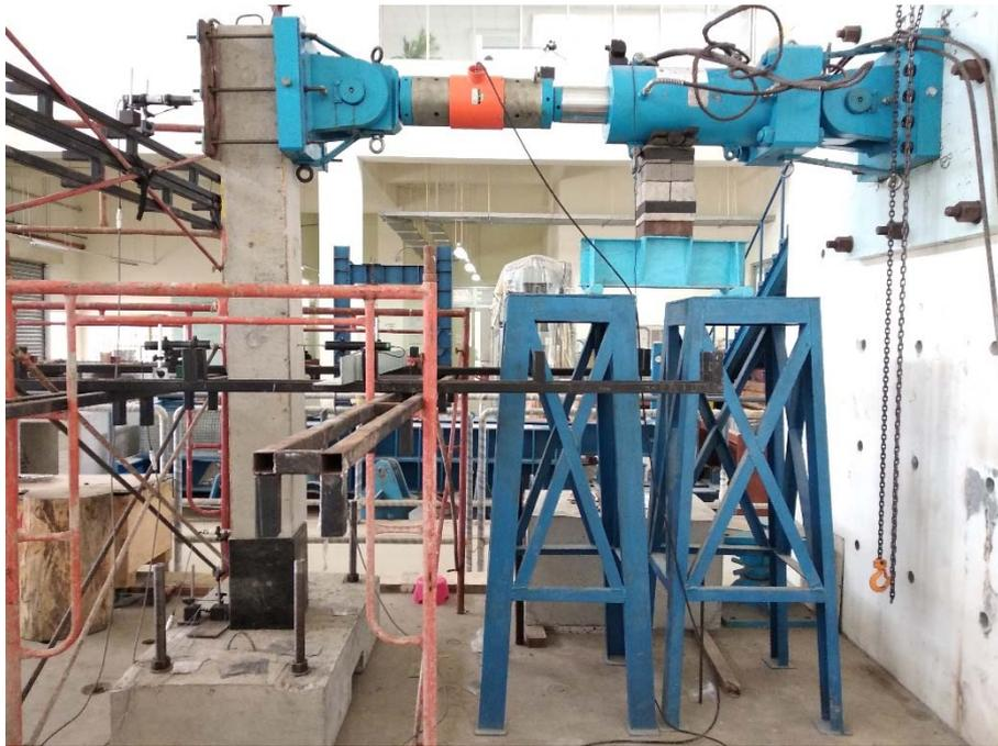
**Pengujian Kekuatan Sepatu Kolom**
