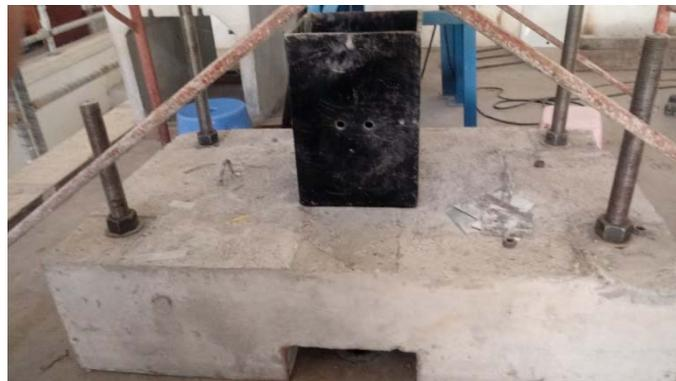
**Gambar 3.13.** Pemasangan SPTK ke *footing*
