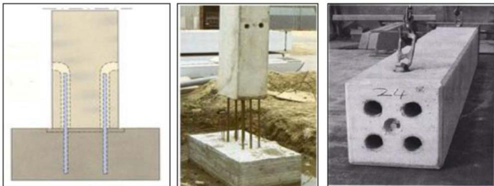
**Gambar 2.12.** Ilustrasi sambungan *Projecting steel bar*
