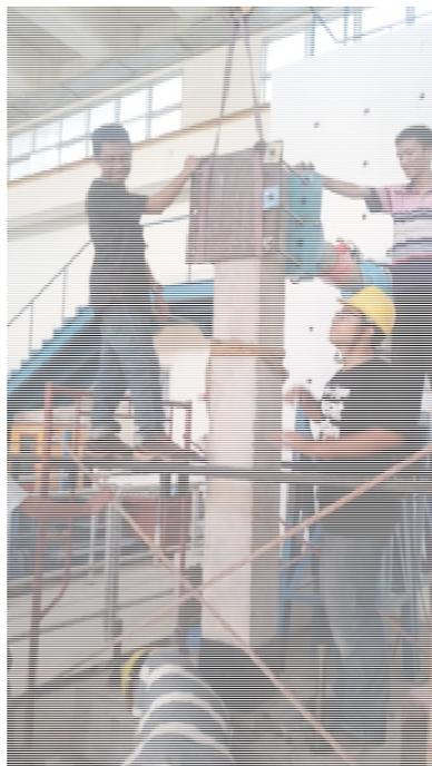
**Gambar 3.15.** pemasangan kolom pada SPTK dan *actuator*
