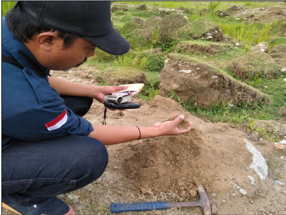
Gambar 19. Litologi permukaan daerah Balaroa berupa pasir halus.
