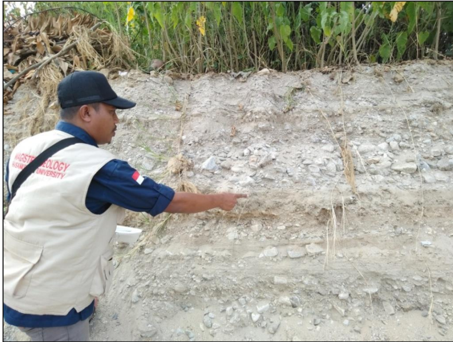
Gambar 30. Litologi Permukaan Daerah Petobo Berupa pasir dan kerikil.
