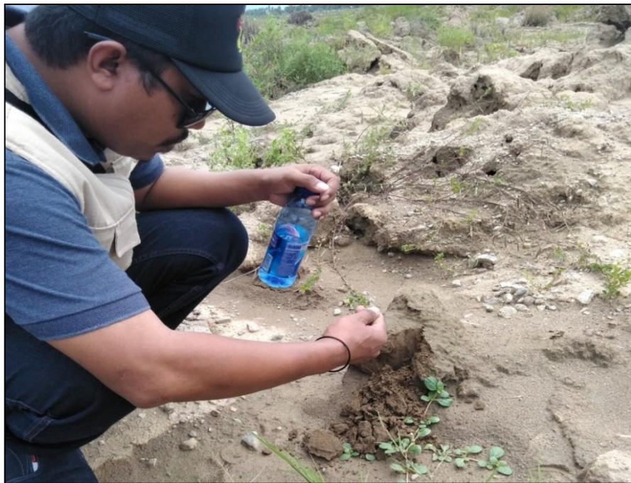
Gambar 29. Litologi permukaan Daerah Petobo berupa lanau dan pasir halus.
