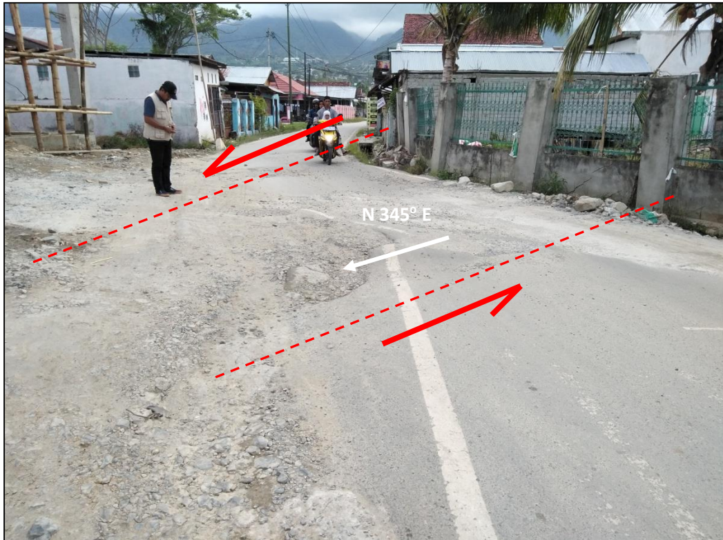
Gambar 44. Foto struktur geologi berupa sesar mendatar mengarah ke kiri ( sinistral ) Jl. Cemara Indah Kota Palu.
