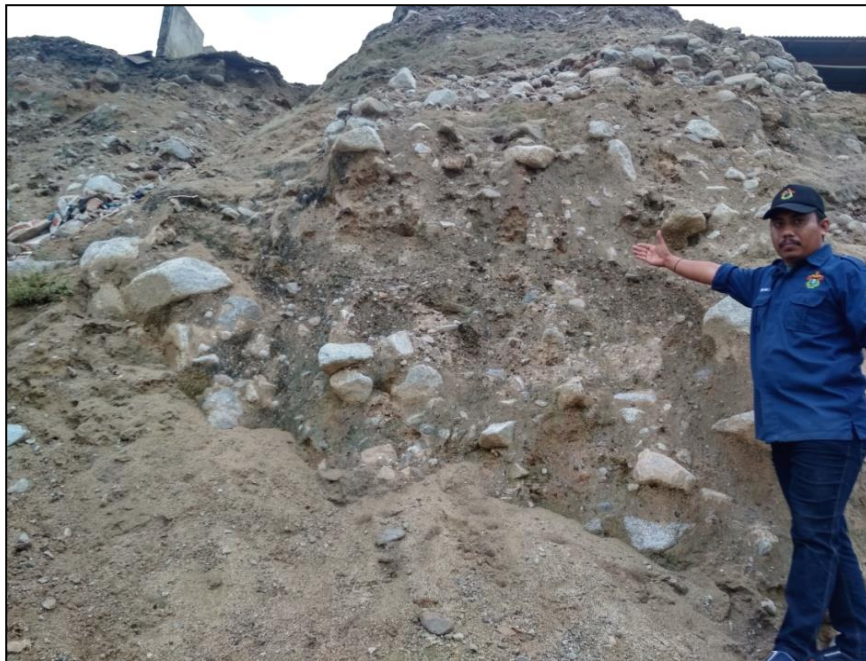
Gambar 18. Litologi Permukaan Daerah Balaroa berupa kerikil pasiran.
