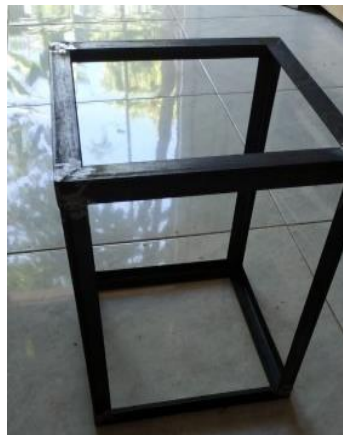
Gambar 4.3 Rangka body dispenser (Sumber: Dokumentasi pribadi)
