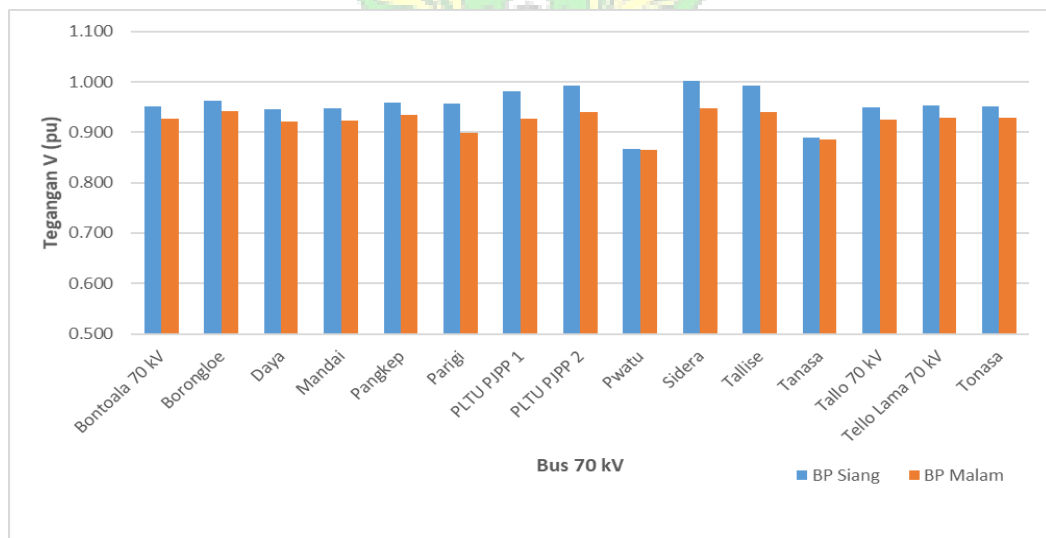
Profil tegangan sistem Sulbagsel 70 kV kondisi daya output PLTB Jeneponto 80% dan PLTB Sidrap 25% pada beban puncak siang dan beban puncak malam
