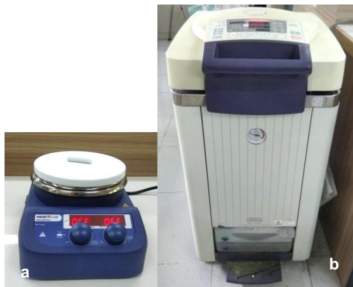
Gambar Lampiran 3b. Alat membuat media PDA. a. Hot plate magnetic stirrer. b. Autoclave
