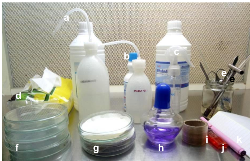
Gambar lampiran 4a. Bahan dan alat yang digunakan pada blotter test. a. Akuades steril; b. NaOCl; c. Alkohol; d. Tisu; e. Botol rendam alat berisi scalpel , gunting, pinset, jarum preparat, cork bohrer ; f. Cawan Petri untuk wadah sterilisasi permukaan; g. Kertas saring/ blotter ; h. Bunsen; i. Plastik wrapping ; j. Korek gas; k. Label dan bolpoin
