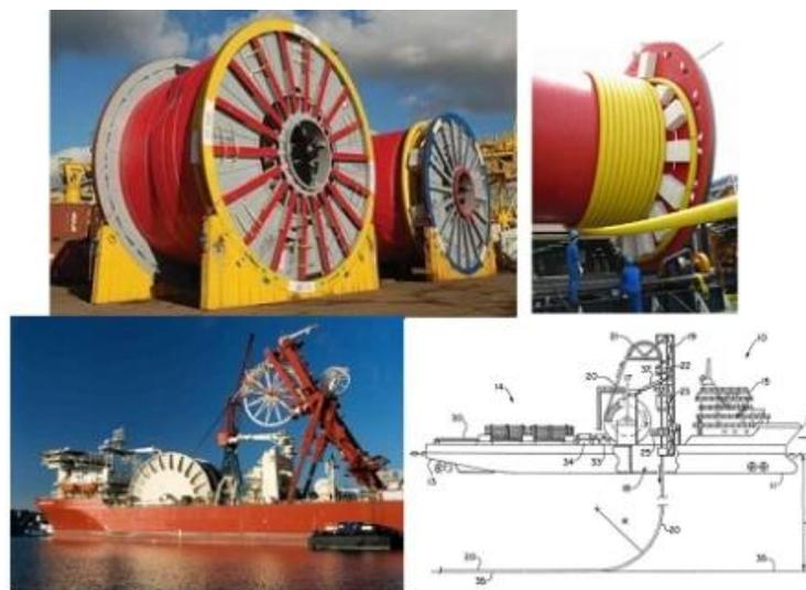
Gambar 2.7 Sketsa metode instalasi *Reel Lay* [18]
