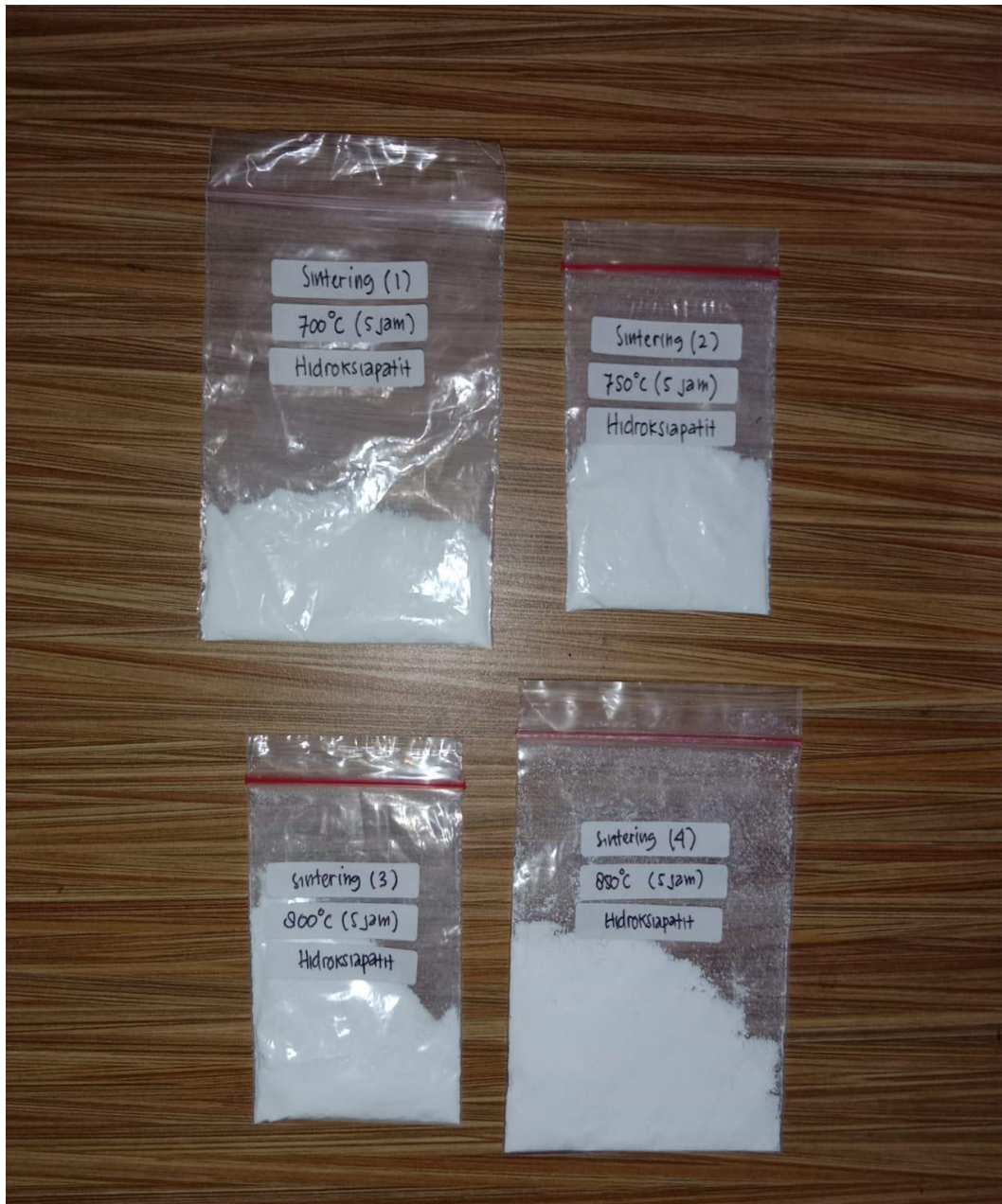
Bubuk setelah sintering (Hidroksiapatit) dengan variasi suhu 700, 750, 800, dan 850°C.
