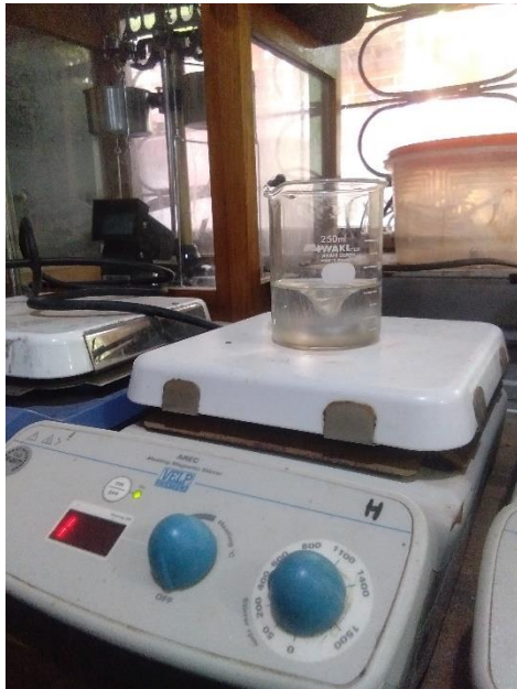
Stirrer (\text{NH}_4)_2\text{HPO}_4 + aquades
