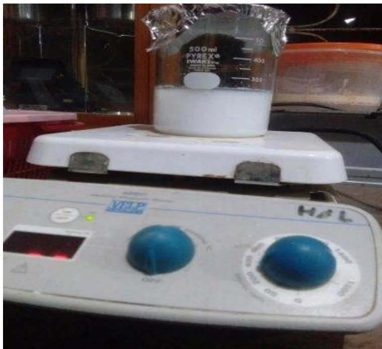
Proses stirrer dari sintesis (Ca(OH) 2 )
