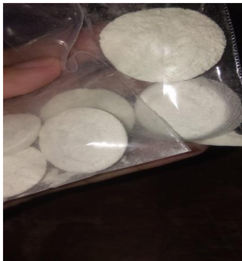
Cangkang kerang setelah dikalsinasi
