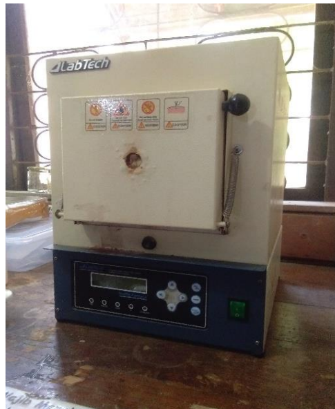
pengeringan endapan menggunakan furnace
