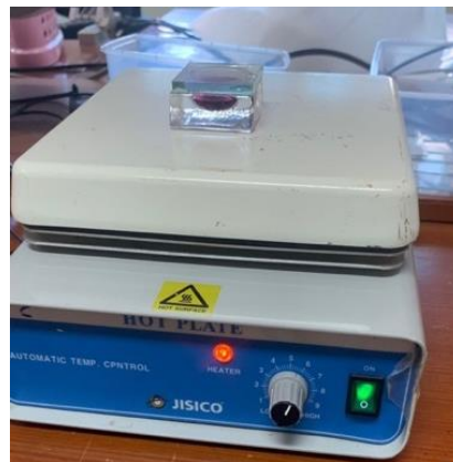
Lampiran Gambar 3. Spesimen dipanaskan pada hotplate yang telah diberikan acid fuchsin (pewarna)
