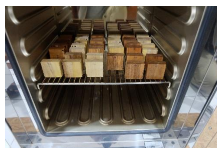
Proses pengujian delaminasi (Sebelum)
