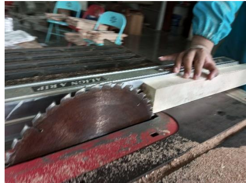
Proses konversi balok menjadi lamina
