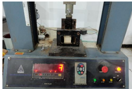
Proses pengujian keteguhan rekat
