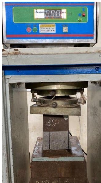
Gambar 3. Pengujian Kuat Tekan Paving block
