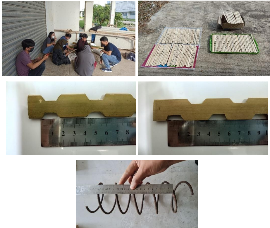
Persiapan Tulangan Bambu dan Tulangan Spiral
