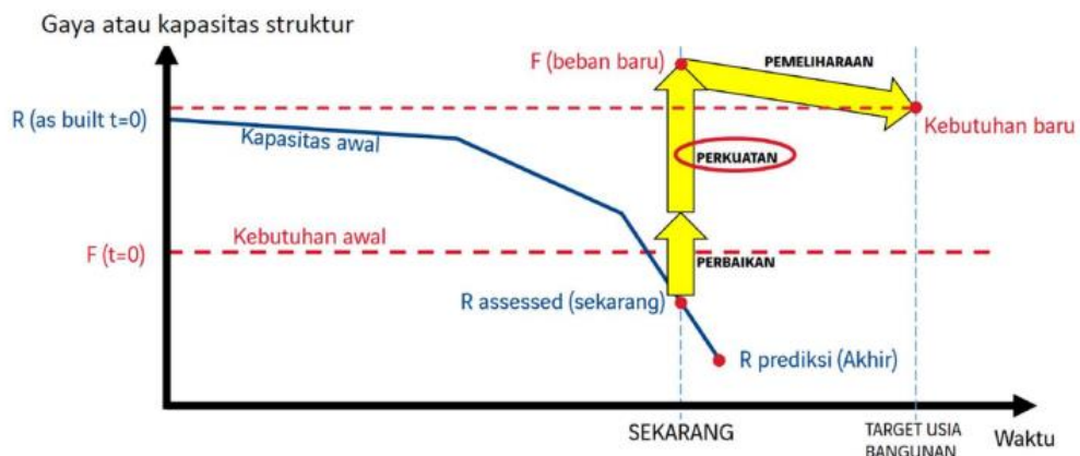
Gambar 9. Konsep Perbaikan Dan Perkuatan Struktur
