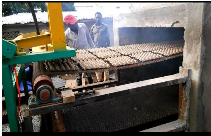
Gambar 2.6 Pengering Rak Telur dengan Ban Berjalan [34]
