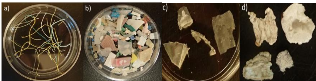
Gambar 2. Contoh bentuk-bentuk mikroplastik (a) fiber; (b) fragmen; (c) film; (d) foam (Wessel et al. , 2016).
