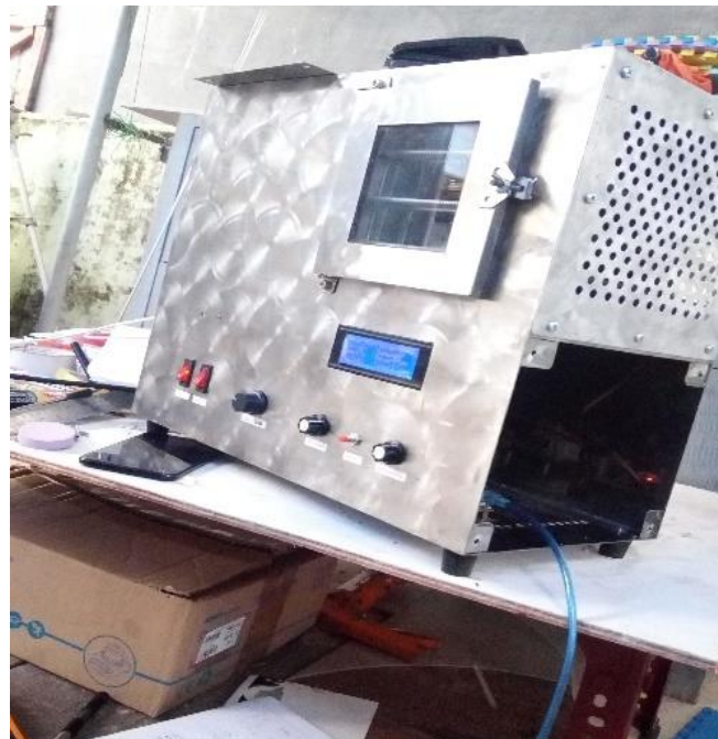
Gambar 2.4. Mesin pengering tipe tray dryer
