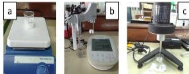
Gambar 24. (a) Proses pembuatan gel thermosensitive, (b) pengujian pH, (c) Pengujian viskositas
