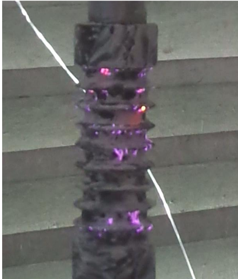
Gambar 6.4 flashover pada isolator resin epoksi yang terkontaminasi polutan kaolin
