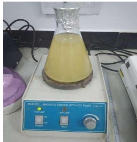
Proses Menghomogenkan Media NA Menggunakan Hot Plate Stirrer
