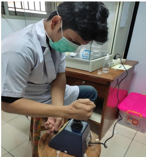
Proses Menghomogenkan Sampel Menggunakan Vortex
