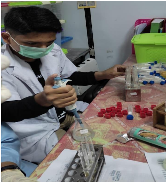
Proses Memasukkan Reagen ke Dalam Tabung Reaksi Berisi Supernatant
