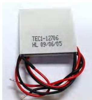
Gambar 13. Modul termoelektrik
