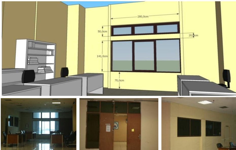
Gambar 61. Bukaan dinding pada kantor BKKBN Menara Balaikota Makassar
