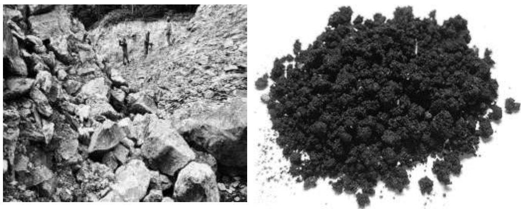
Gambar 3. Asbuton bongkahan dan LGA
