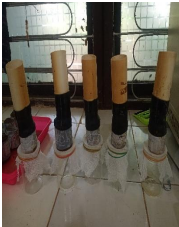
Pengujian Permeabilitas Tanah
