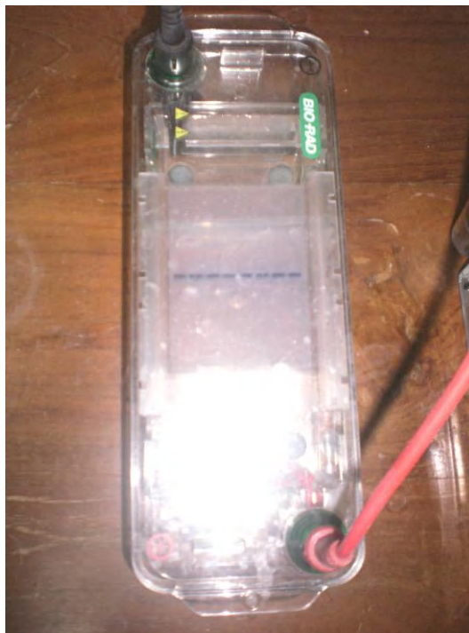
Gambar Lampiran 5. Hasil isolasi DNA markisa dielektroforesis untuk melihat ada atau tidaknya pita DNA menggunakan alat elektroforesis Bio-rad .
