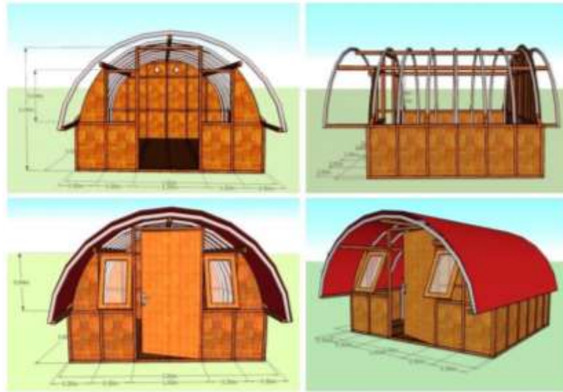
Gambar 9. Sketsa konsep hunian sementara lumbung bambu
