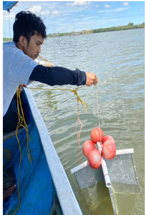
Gambar 12. Pemasangan sediment trap dan pengukuran kecepatan arus
