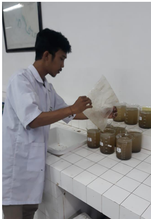
Gambar 14. Proses pengendapan sedimen di Laboratorium
