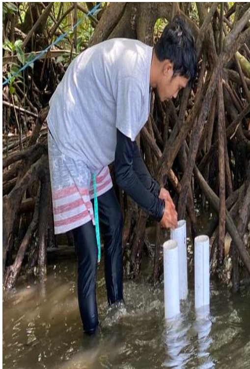
Gambar 12. Pemasangan sediment trap dan pengukuran kecepatan arus
