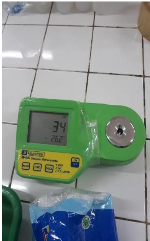
Gambar 13. Analisis salinitas perairan Sungai Tallo, di Laboratorium
