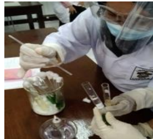
Mencelupkan ose ke dalam tabung yang berisi BGLB
