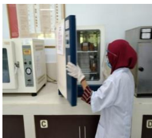
Memasukan kembali tabung reaksi ke dalam inkubator
