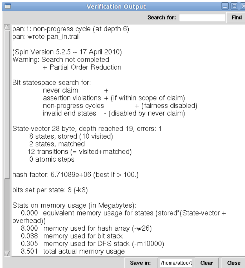
Gambar 4.18 Hasil Verifikasi untuk spesifikasi Liveness Condition
