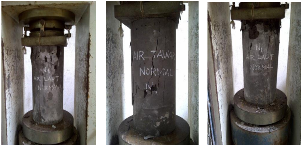
Gambar 4.2 Pengujian Kuat Tekan Beton
