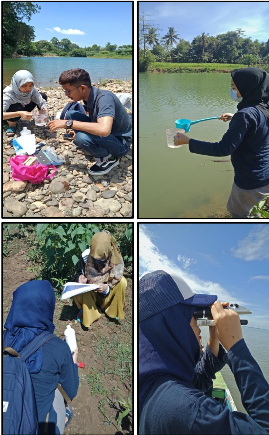
Gambar S17. Pengukuran parameter air in situ (salinitas, TDS, pH, EC, Suhu)
