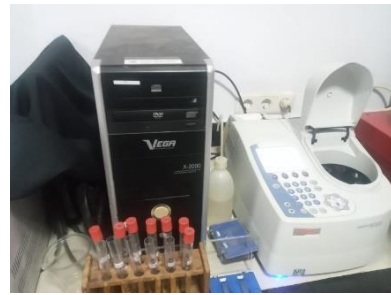
Pengukuran absorbansi isolat dengan menggunakan Spektrofotometer
