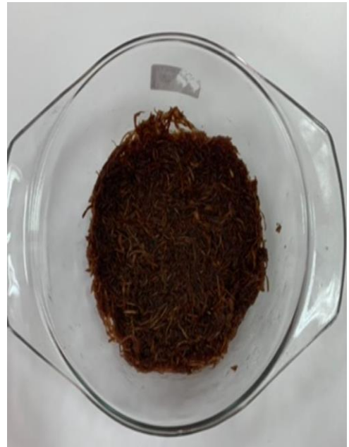
Sampel direndam dengan NaOH 30% selama 1 ja
