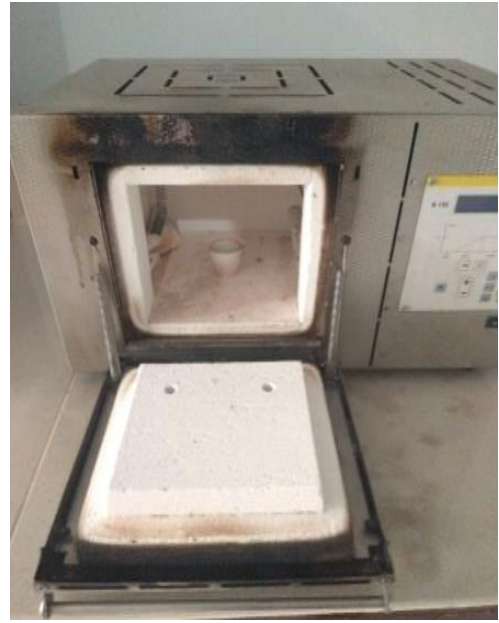
Sampel dimasukkan ke dalam tanur selama kurang lebih 6 Jam.
