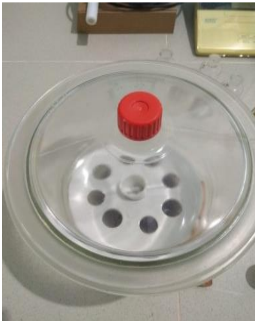
Sampel kemudian di masukkan ke dalam desikator untuk di pendinginan.
