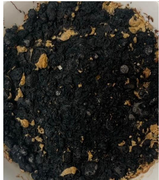
Biochar ampas sagu setelah pretreatment 450 Watt.
